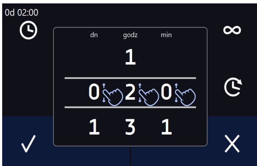
Rys. 38. Szybka zmiana zadanego czasu - ustawienie wartości
