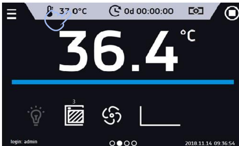
Rys. 36. Szybka zmiana temperatury- ustawienie wartości
