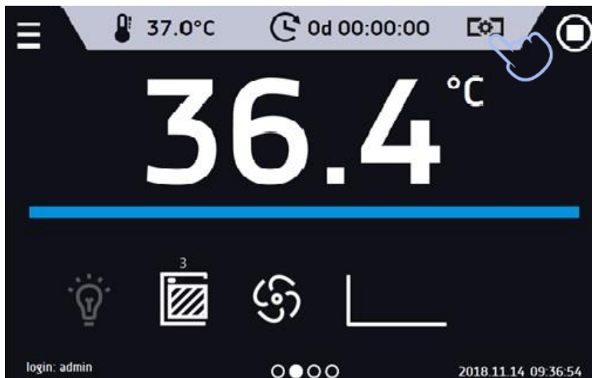
Rys. 40. Szybka zmiana wydajności wentylatora
