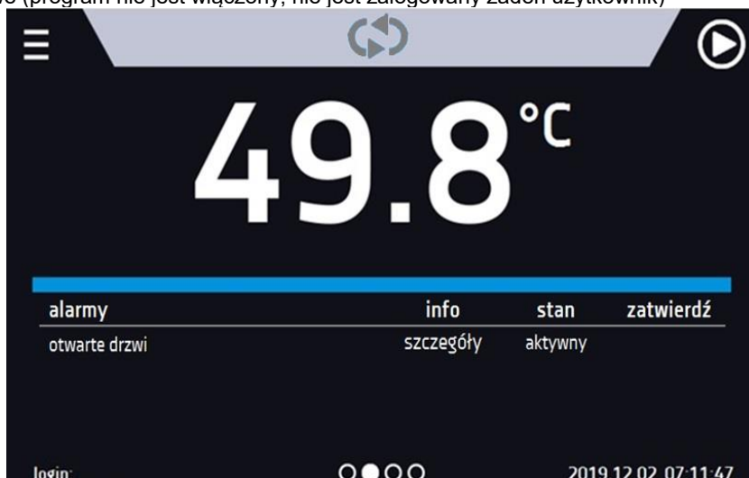
Rys. 9. Okno bazowe (program nie jest włączony, nie jest zalogowany żaden użytkownik)
